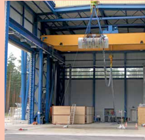
Bild a: Falltest mit Transportbehälter GNS
